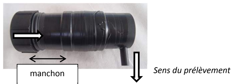
Figure 5 : cassette modifiée pour le prélèvement à l'intérieur des masques respiratoires
